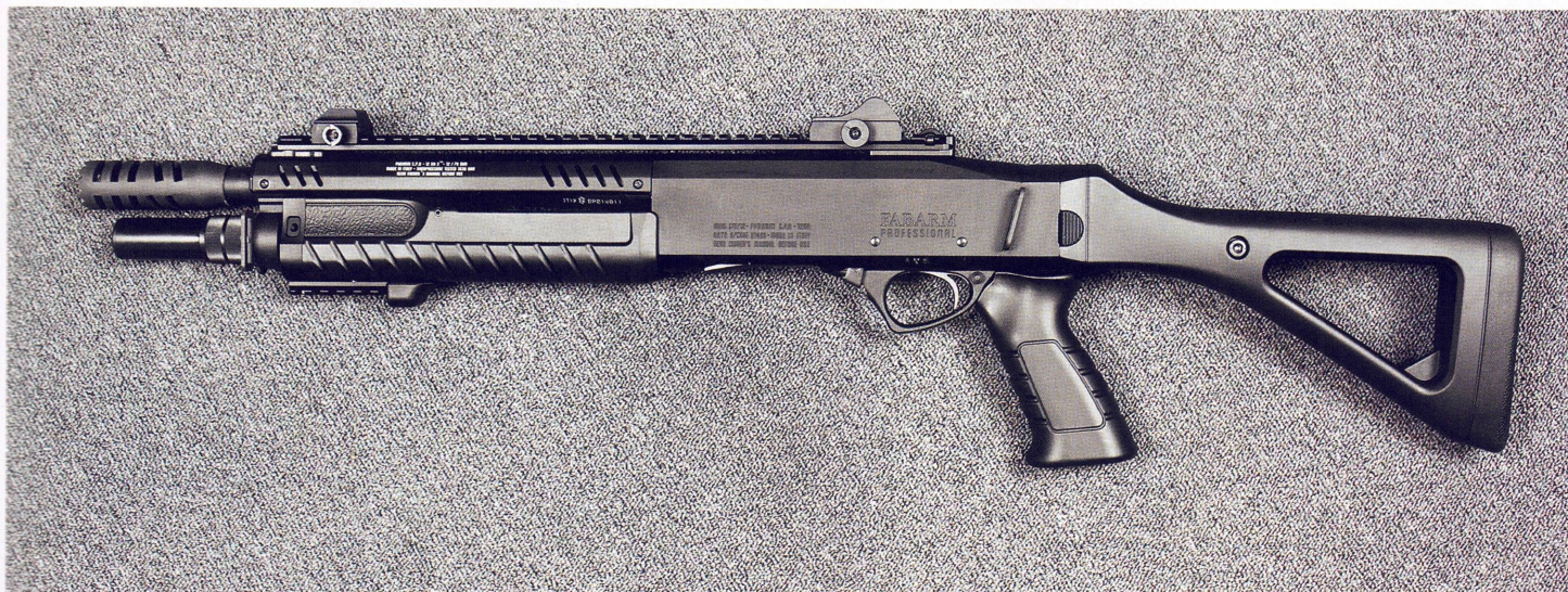
Brokovnice STF/12 Compact osazená na ventilovaném krytu hlavně snímací Picatinny lištou se snímacími pevnými mířidly
