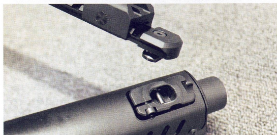
Dlouhá horní Picatinny lišta se dá sejmout za několik vteřin zcela jednoduše a stejně tak i znovu nainstalovat
