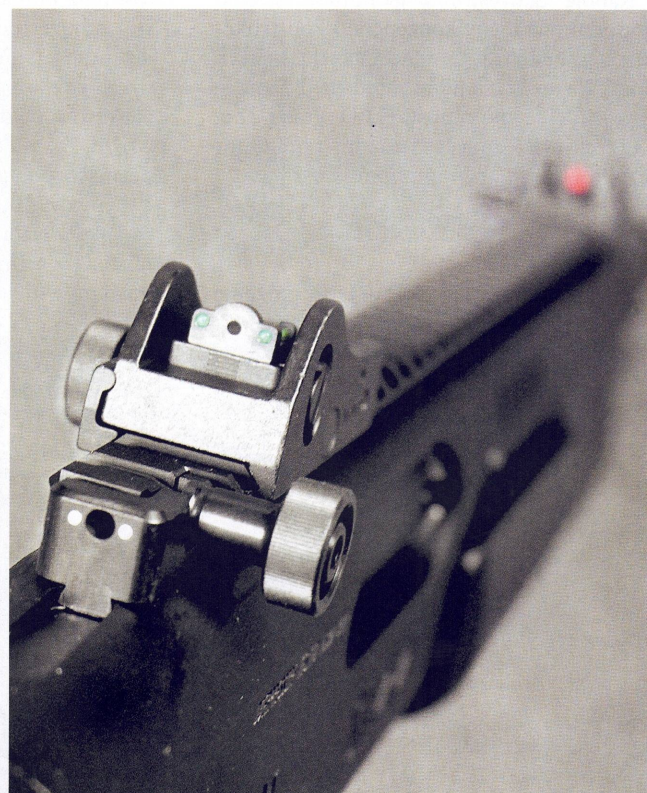
Mířidla na Picatinny liště jsou se světlovodným vláknem, mikrometrický hledí je typu „ghost ring“. Pod lištou jsou na zbrani ještě menší pevná mířidla zvýrazněná bílými tečkami
